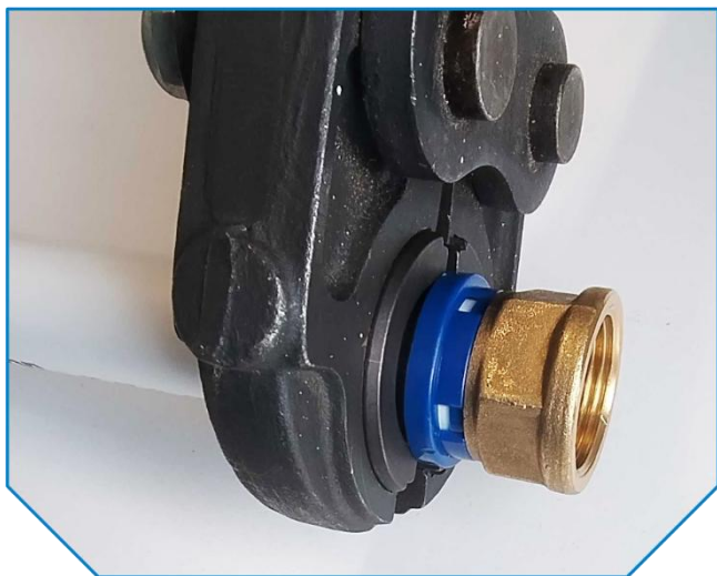
Przyłożenie szczęki „U” do złączki na rurze o średnicy 25 mm. Widok 1 w zaciskarce.
