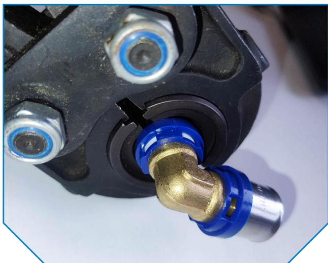
Przyłożenie szczęki „U” do złączki na rurze o średnicy 20 mm. Widok 1 w zaciskarce.
