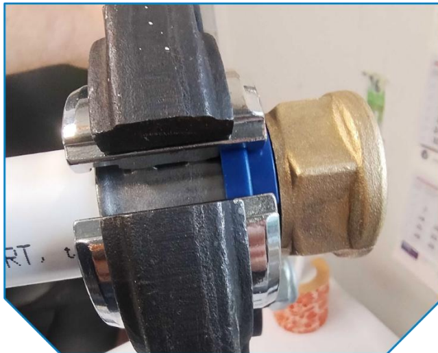
Złączka na rurze o średnicy 25 mm włożona do szczęki „TH”. Widok 2 w zaciskarce.
