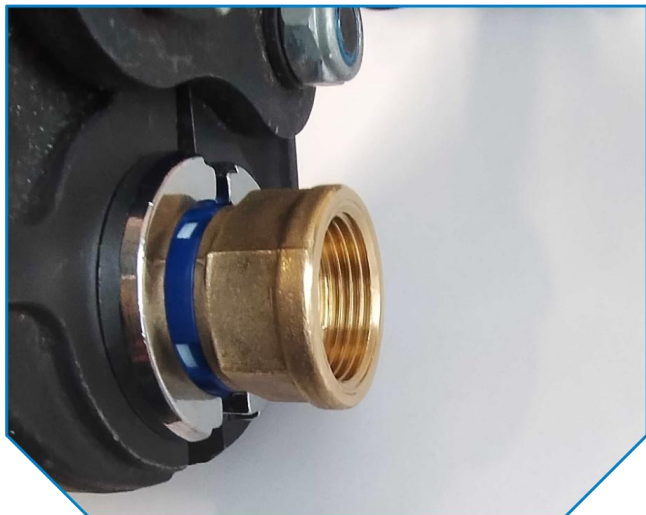
Złączka na rurze o średnicy 25 mm włożona do szczęki „TH”. Widok 1 w zaciskarce.
